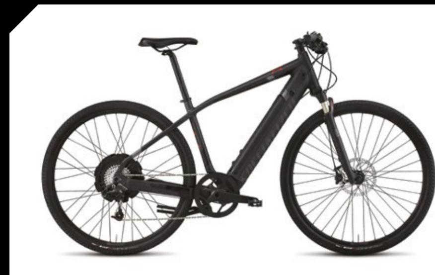
A Specialized Turbo X combina velocidade e estilo. Uma E-Bike que tem como principal atrativo o fato de atingir 45km/h de velocidade máxima. A bike é do tipo Pedelec, ou seja, o auxílio elétrico só entra em ação se o ciclista pedalar. A bateria de lítio de 432Wh fica alojada ao longo do downtube e pode ser destacada da bike e recarregada em duas horas. A bateria também é recarregada ao serem acionados os freios. O motor de 250 Watts é do tipo Direct Drive que atua diretamente na roda traseira.
