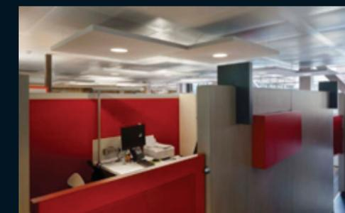
Divisórias suspensas, fixadas com cabos de aço ou placas fixadas no chão garantem privacidade e conforto acústico
