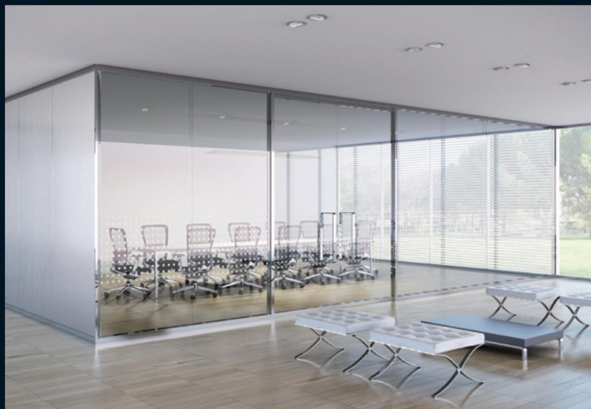
A norma da ABNT NBR 15141, de 2008, especifica as características físicas e dimensionais, classificando as divisórias modulares removíveis do tipo piso-teto para escritórios. É formada por sistema construtivo, que separa espaços internos da edificação, compartimentos, definindo ambientes, estendendo-se do piso ao forro ou teto, sendo constituído por painéis
