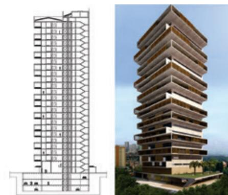
Para concepção da forma criou-se um módulo de 24 x 30 m, optou-se pela sobreposição de retângulos pousados uns sobre os outros, ocasionando uma forma mais fluída, optando por linhas retas com ângulos de 90°. O projeto busca atingir alguns princípios da arquitetura bioclimática, se utilizando de tetos jardins, abertura de grandes vãos voltadas para fachadas com maior índice de ventilações naturais.
